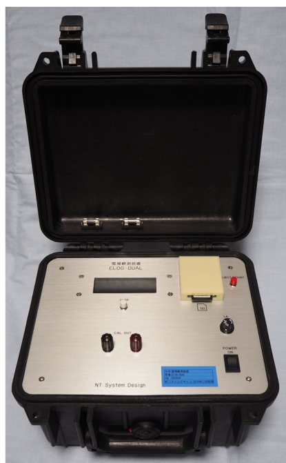
MT観測用 電場観測装置 ELOG-DUAL
