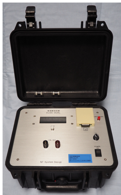
MT観測用 電場観測装置 ELOG-DUAL
