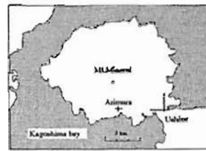
図1 桜島の地電位差観測点の概念図。有村(間隔100m)牛根(間隔2km)。
