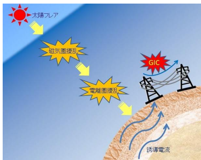
図 2.8.1 地磁気急変現象による地中誘導電流（GIC）
