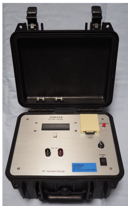
MT観測用 電場観測装置 ELOG-DUAL
