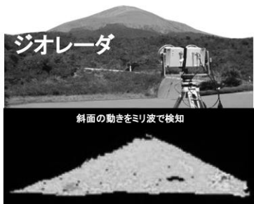
ジオレーダはミリ波あるいはマイクロ波帯の電波を照射し、火山や地滑り斜面、鉱山切羽などで反射した成分を受信します。受信記録に差分干渉解析を適用することで、観測ターゲットの微小変位を常時モニタリングすることができます。レーダアンテナは水平及び垂直方向に回転する機構を備えていますので、面的なデータ集録が可能となります。
