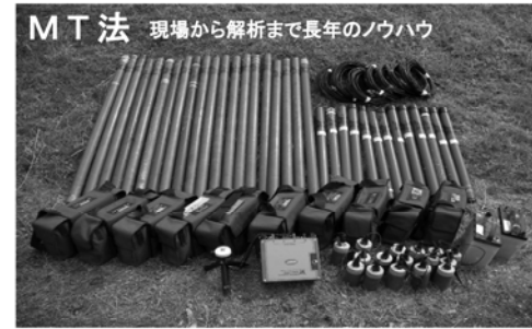
MT法 現場から解析まで長年のノウハウ MT法電磁探査は、自然の電磁場信号を用いて行なう比抵抗探査手法です。他の比抵抗探査手法よりも探査深度が深く、地下数十kmまで探査が可能です。このため、地殻構造調査や地熱構造調査に多くの実績があります。また、測定周波数の高いAMT (Audio Frequency MT) 法探査を用いることにより、地下1km程度までの詳細な探査も可能で、トンネル掘削前の土地地質調査や断層調査への実績があります。測定システムは可搬性に優れ、騒音振動はありません。
