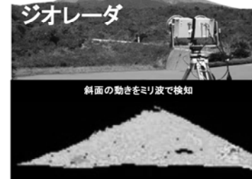
ジオレーダはミリ波あるいはマイクロ波帯の電波を照射し、火山や地滑り斜面、鉱山切羽などで反射した成分を受信します。受信記録に差分干渉解析を適用することで、観測ターゲットの微小変位を常時モニタリングすることができます。レーダアンテナは水平及び垂直方向に回転する機構を備えていますので、面的なデータ集録が可能となります。
